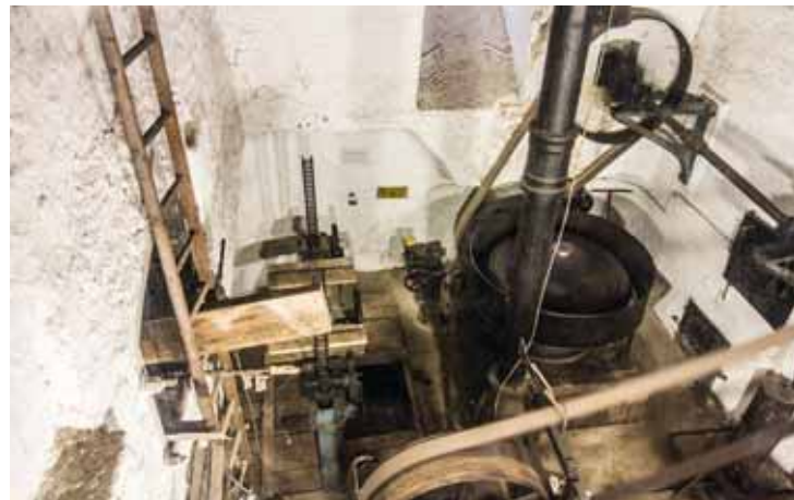
Eine per Wasserrad angetriebene Welle leitete die Kraft über Transmissionen auf Kolbenpumpen, die das Wasser in die Höhe beförderten. Heute wird mit ihr ein Generator betrieben, der Strom für das Gebäude und das öffentliche Netz erzeugt.
