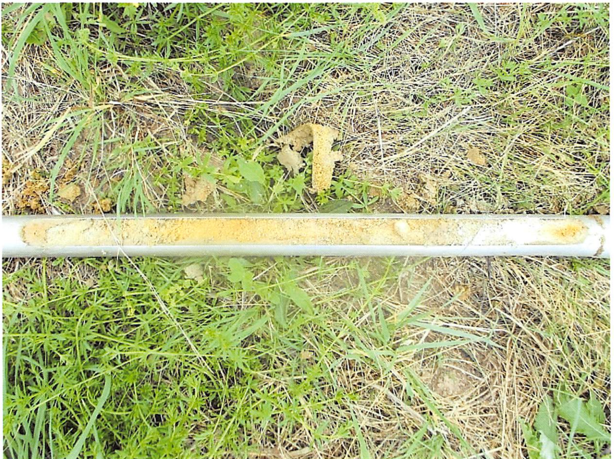
Bild 6: NO-Ecke, tieferer Bereich bis 5,0 m, Mittelsand, stark schluffig.
