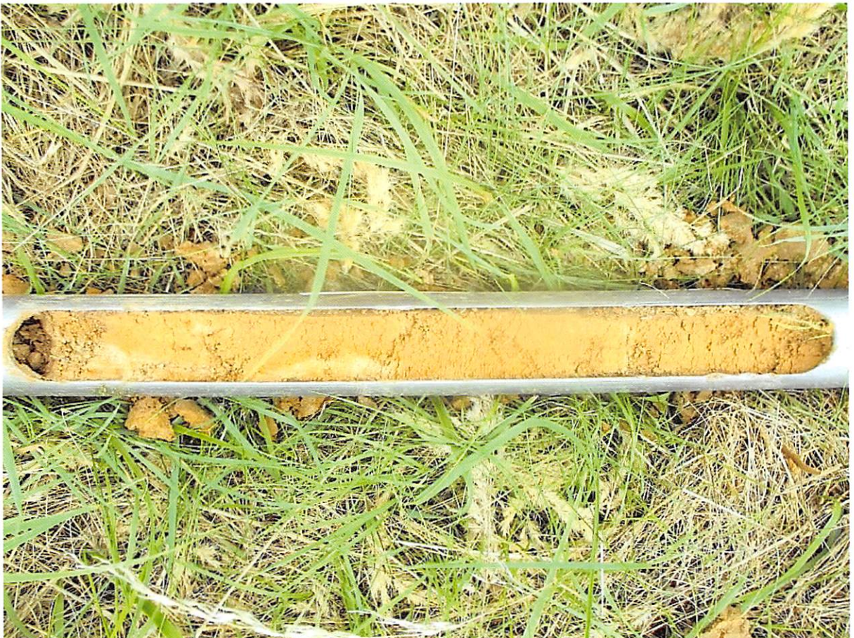
Bild 4: NW-Ecke, Bereich 0,5-1,0 m, Geschiebelehm, stark feinsandig.
