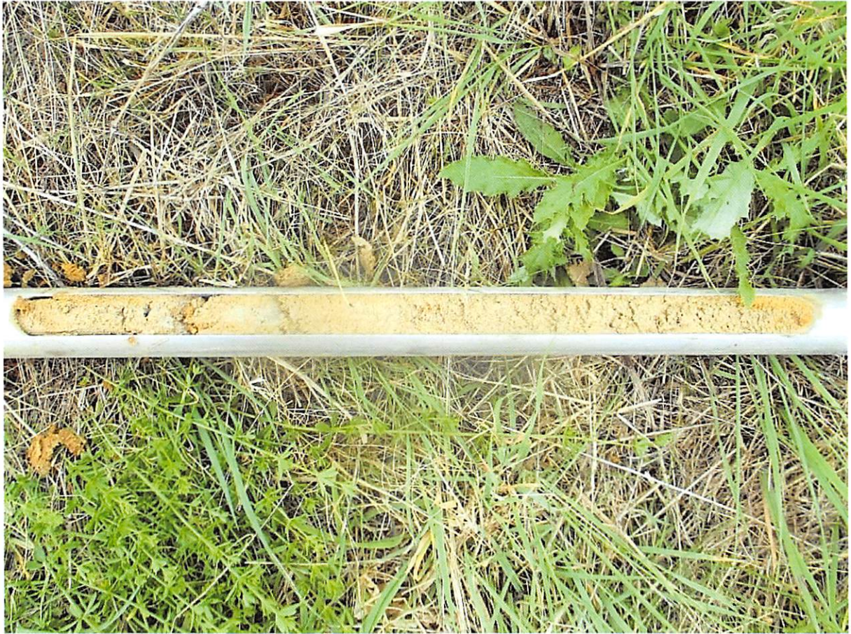
Bild 5: N-Seite, Bereich 2,5-3,0 m, Geschiebelehm, stark sandig, schwach kiesig / tonig.
